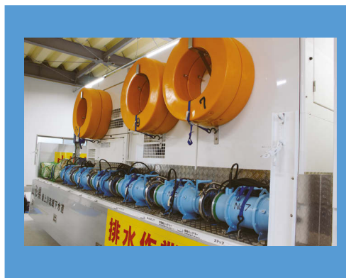
写真－2 令和3年度に配備した排水ポンプ車 水中ポンプ24台で排水を行う
