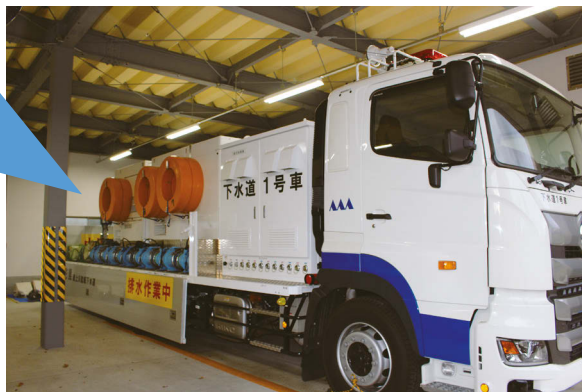
写真－2 令和3年度に配備した排水ポンプ車 水中ポンプ24台で排水を行う
